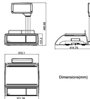
Cette **balance poids prix avec ticket** dispose d'un affichage sur les deux côtés de son indicateur disposé en hauteur pour une parfaite lisibilité par le vendeur et par le client.
